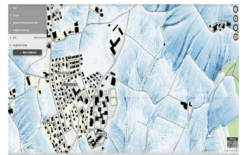
Fliesswegkarte zum Erosionsrisiko. © geo.admin.ch
