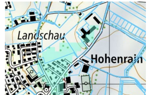
Türkis eingefärbte Bereiche zeigen die Flächen mit einer Hangneigung unter 2 %. © geo.admin.ch
