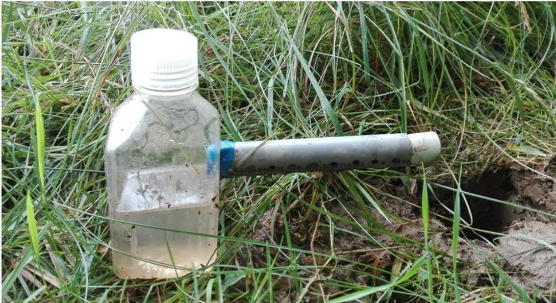
*Abbildung 32: Bild eines gefüllten Oberflächenabflusssammlers (OAS 3, 11.7.2017).*
