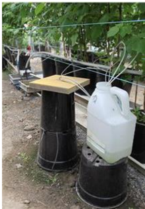
Auffangschale zur Wassergabemessung von zwei Tropfer
