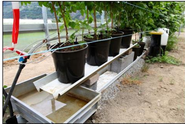
Auffangschale zur Drainwassermessung von drei Töpfen
