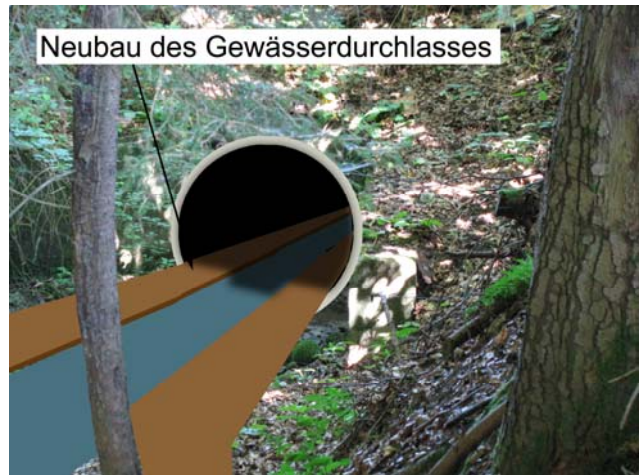
Foto 17-4: Dritter Gewässerdurchlass Mühlebach an der Kantonsstrasse K56a (Massnahme GD3)
