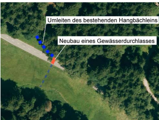
Foto 40-7: Massnahme NB1: Neubau eines Gewässerdurchlasses an der Strasse Sagenhof - Tschädigen
