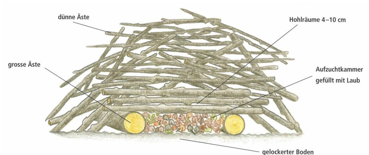
Abbildung 2: Aufbau eines Asthaufens mit Aufzucht-kammer für Wiesel
