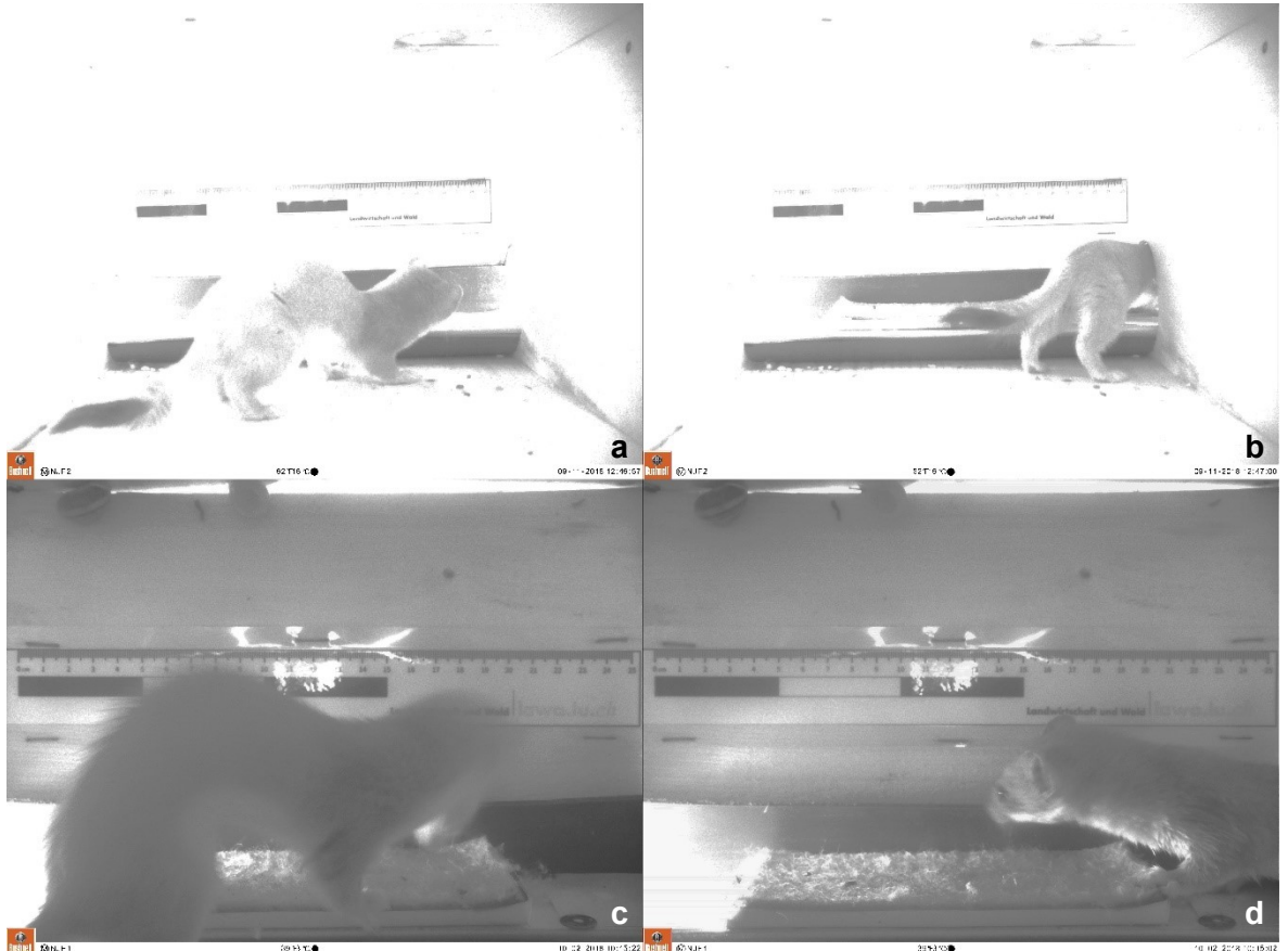
Abbildung 14: Im direkten Vergleich ist der Aufnahmebereich der langen Fotokisten (460 mm Nahlinse, a und b) besser als derjenige der kurzen Fotokiste (250 mm Nahlinse, c und d). Bei der Verwendung der 250 mm Nahlinse ist der Fokus so nahe am Objekt und der Bildwinkel so klein, dass nicht die ganze Körperlänge eines Hermelins ins Bild passt (c).
